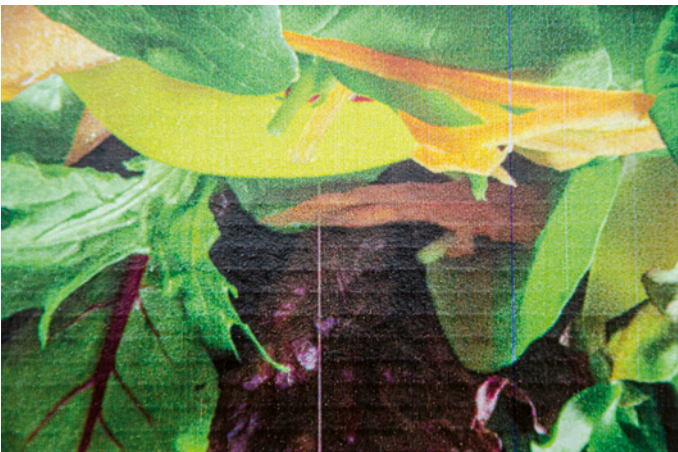
Streifenbildung durch verstopfte Düsen ist einer der häufigsten Druckfehler im Digitaldruck
